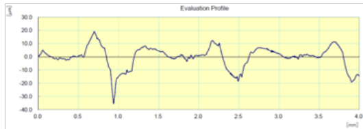
(d) Surface Roughness plot after chemical vaporization
